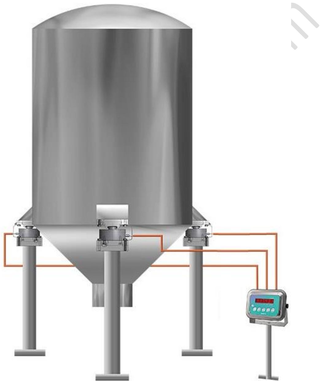
سنسورهای لودسل بین مخزن و پایه‌های آن قرار می‌گیرند
